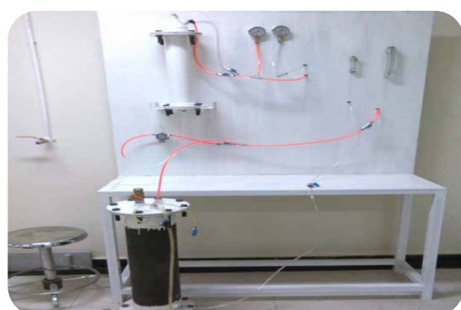
شکل ۳- دستگاه تولید فوم در آزمایشگاه
