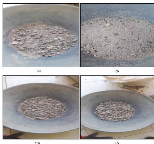
شکل ۱۵- نمودار دانه‌بندی و نمایی از دانه‌بندی خاک‌های مورد استفاده در آزمایش تأثیر ضریب یکنواختی
