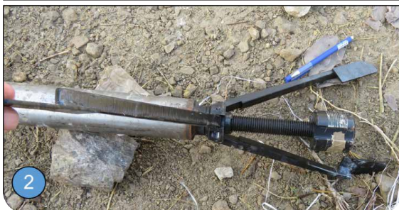
شکل ۶- قفل کننده گوه در دو حالت بسته (۱) و باز (۲)
