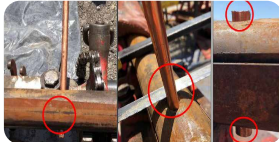
شکل ۷- نحوه اتصال گوه به برش‌دهنده به وسیله مفتول مسی
