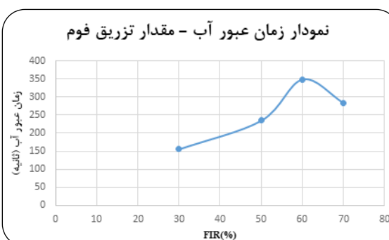
شکل ۶- نمودار زمان عبور آب با تغییر FIR در یک FER و رطوبت ثابت
