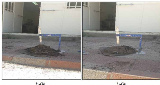
شکل ۴- حالت‌های مختلف به وجود آمده از آزمایش اسلامپ خاک‌ها در FER = 12 و FIR های مختلف
