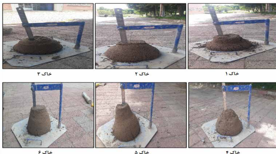
شکل ۵- حالت‌های مختلف به وجود آمده از آزمایش اسلامپ خاک‌ها در FER = 7/5 و FIR های مختلف
