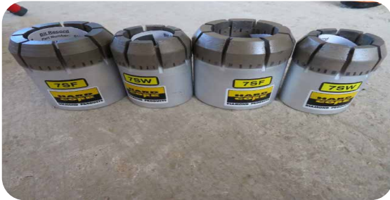
شکل ۹- سرمته مخصوص حفاری انحرافی
