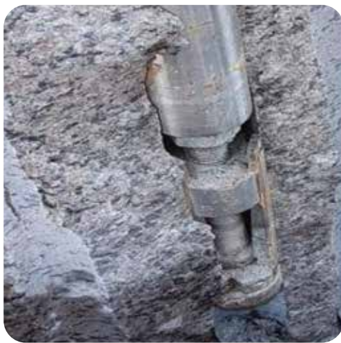
شکل ۱۳- بازیابی گوه در تونل‌های استخراجی
